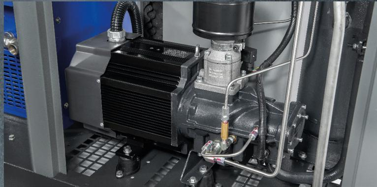
**EINSTUFIGER SCHRAUBENBLOCK** wird direkt vom Motor angetrieben und ist ohne Getriebe, Riemen und Riemenscheibe verbunden. Die Übertragungsrate beträgt 100% und der Wirkungsgrad ist im Vergleich zu einem Asynchronmotor mit gleicher Spezifikation um 2-3% verbessert. Diese Direktantriebe bedeuten geringere Wartungskosten. Es werden keine Keilriemen verwendet dadurch wird ein höherer Wirkungsgrad erreicht, da keine Schlupfverluste oder zu fest gespannte Keilriemen verwendet werden.
